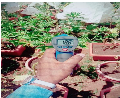
Figure 8 : Mesure de la température des feuilles à l'aide d'un thermomètre IR.
