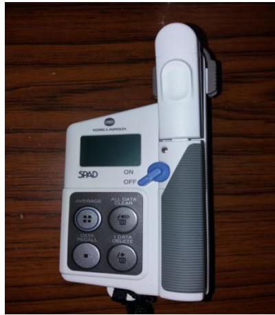
Figure 6: Appareil de chlorophyllomètre de model SPAD-502.
