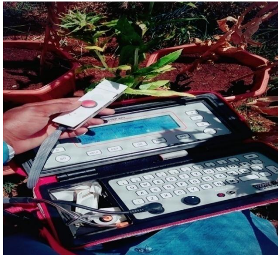
Figure 7: Mesure de la conductance stomatique à l'aide d'un poromètre AP4.
