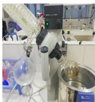
Figure 10 : Elimination des solvants par rotavapor
