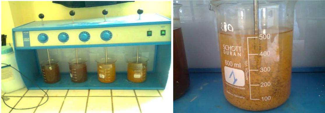
Figure 31 : Appareillage de Jar-Test
