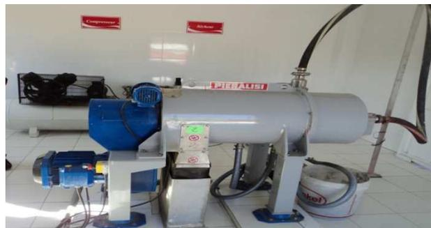
Figure 13 : centrifugeuse des boues séparées de la STEP de la CBGN
