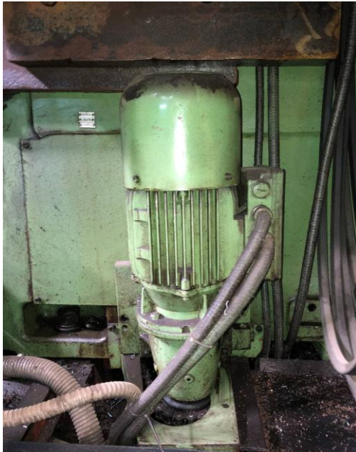
Figure 21: moteur asynchrones (translation vertical de la serre flanc)
