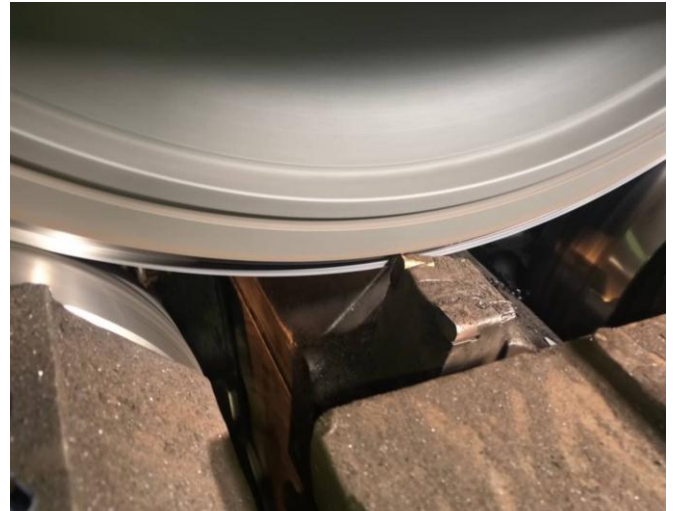
Figure 9 : reprofilage de la partie extérieure de la roue.
