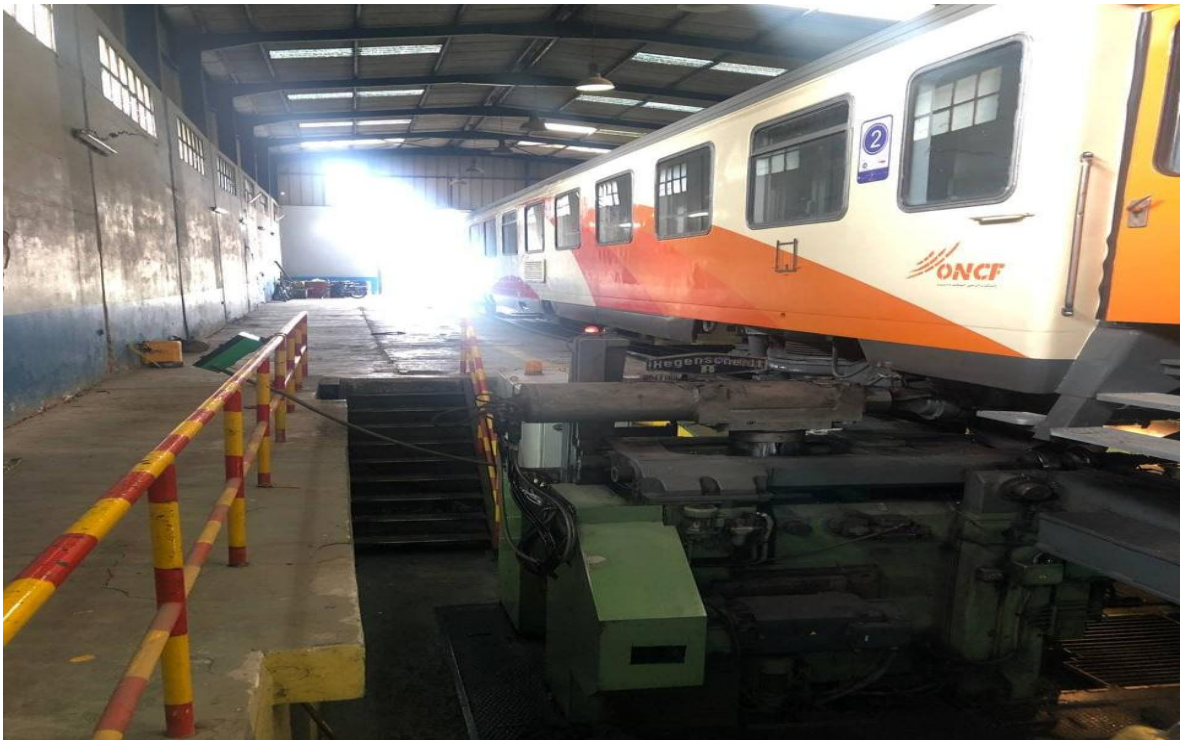
Figure 2 : Atelier du tour en fosse
