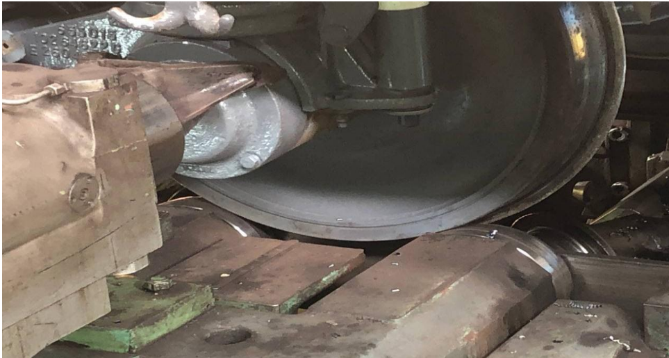
Figure 6 : Une roue placée entre 2 galets
