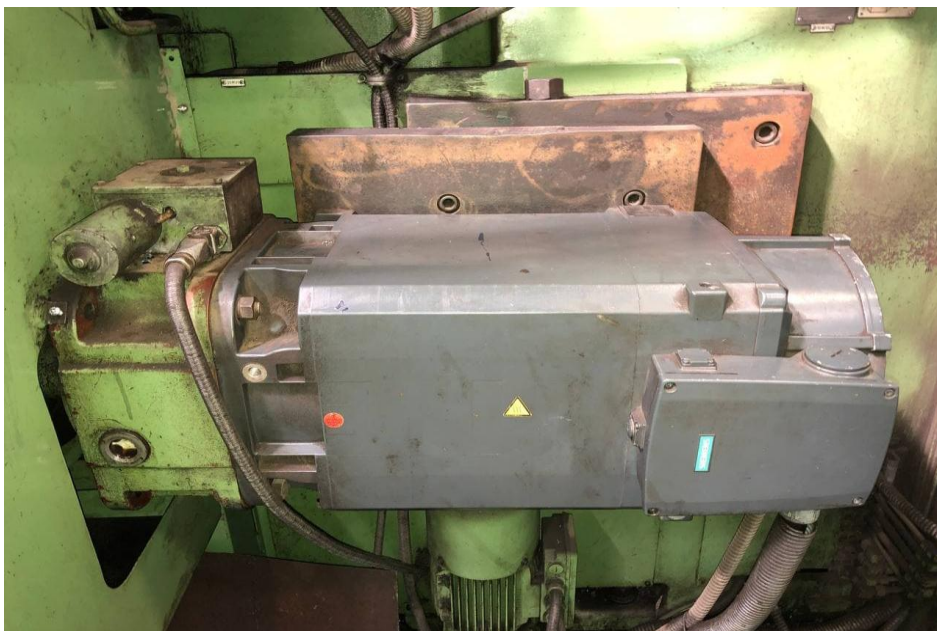
Figure 19: moteur asynchrone entraine les galets
