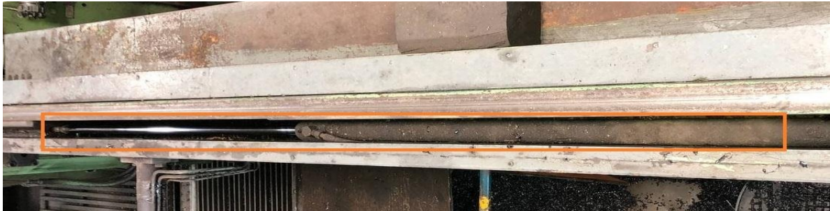
Figure 28: vérin (déplacement des rails mobiles)
