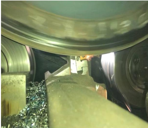
Figure 8 : reprofilage du boudin.
