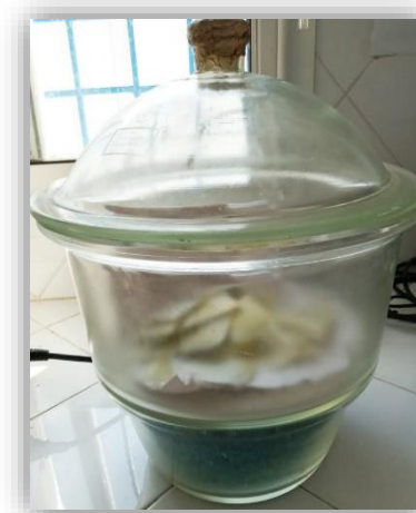
Photo 19 : Refroidissement des sacs filtrants dans le dessiccateur
