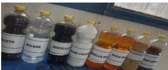
*Figure 7: Les collets, l'hexane, le miscela brute, la soude caustique, le miscella neutre, l'huile neutre, la farine entrée DT, la farine sortie DT*
