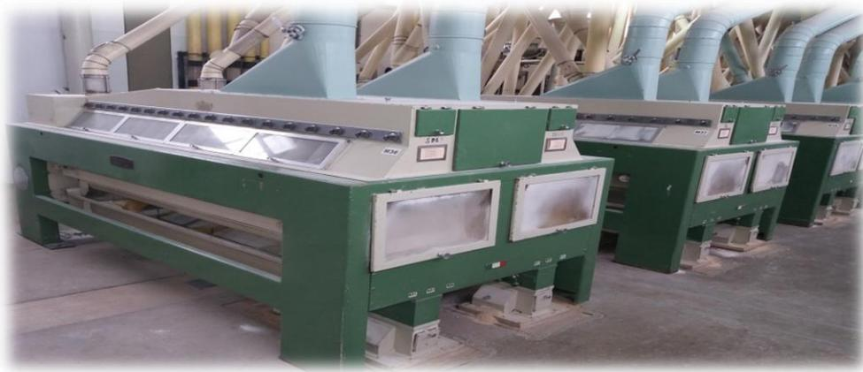
Figure 8: Photo d'un sasseur
