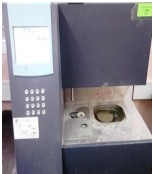
Figure 17: L'appareil de Vicat + prisomètre automatique CONTROLAB ACMEEL
