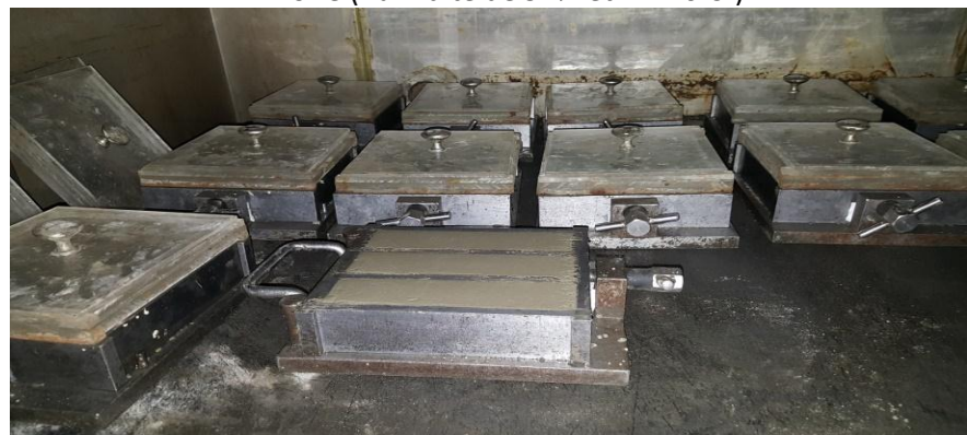
Armoire (humidité de 97% et T = 20 C°)
