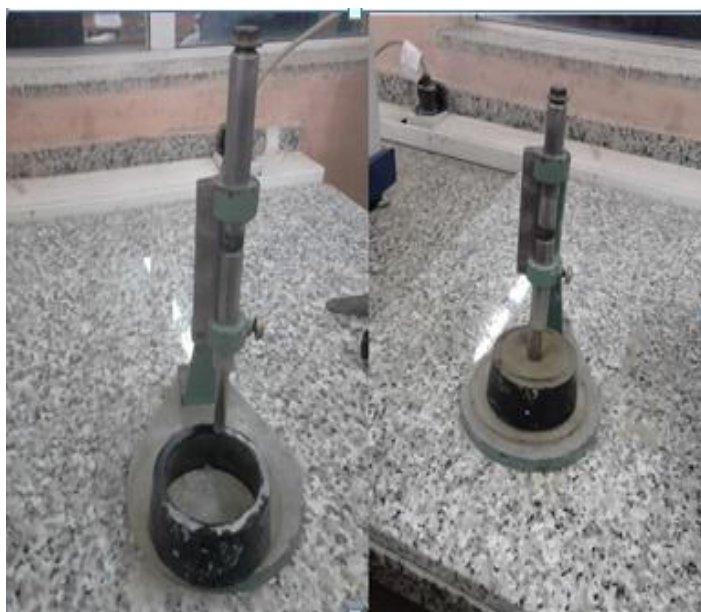
Figure 17: L'appareil de Vicat + prisomètre automatique CONTROLAB ACMEEL
