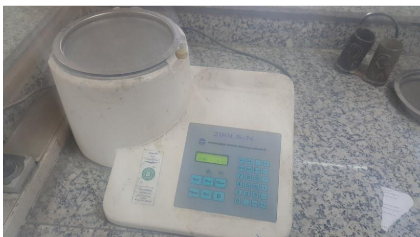
Figure 16 : Tamiseur avec différente diamètres (200 ; 90 ; 45 um
