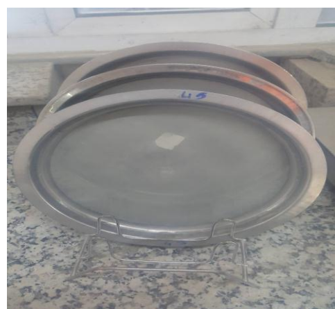
Figure 16 : Tamiseur avec différente diamètres (200 ; 90 ; 45 um
