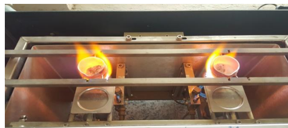
Figure 14 : Appareil Perl'X3 + creuset et nacelle en platine
