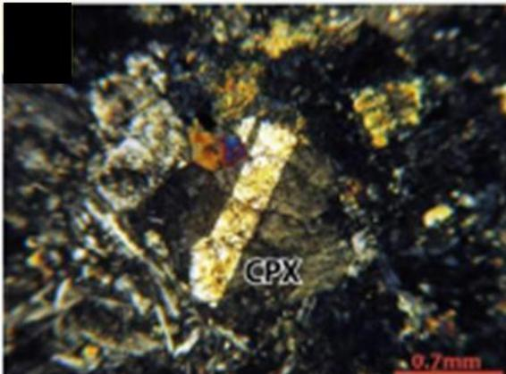
*Photo 11 : Aspect microscopique d'un basalte (Belkacim, 2014).*
