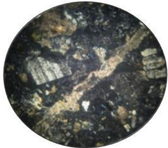
**Photo 10** : Aspect *microscopique* des tufs cristallins lithiques (Gr. : x 40, LPA).
