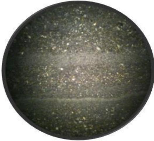
**Photo 9** : Aspect *microscopique* des tufs cristallins lités montrant une alternance des lits fins et lits grossiers (Gr. : x 40, LPA).
