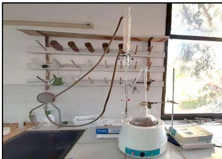
**Figure 3 : Montage de Clevenger (Photo originale prise au laboratoire LIMOME, 2021, dans le cadre de ce projet)**
