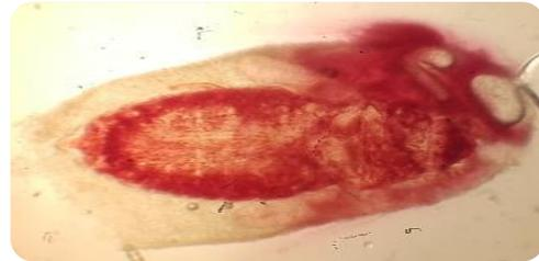
**Figure 23-b** - Observation sous microscope optique d'un échantillon de cire traité au NPc au 1/20 (grossissement x40)
