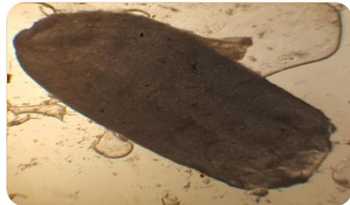
**Figure 21-b** - Observation sous microscope optique d'un échantillon de cire traitée à l'eau (grossissement x40)
