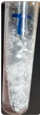
**Figure 21-a** - Observation à l'œil nu d'un tube à essai contenant un échantillon de cire traitée à l'eau
