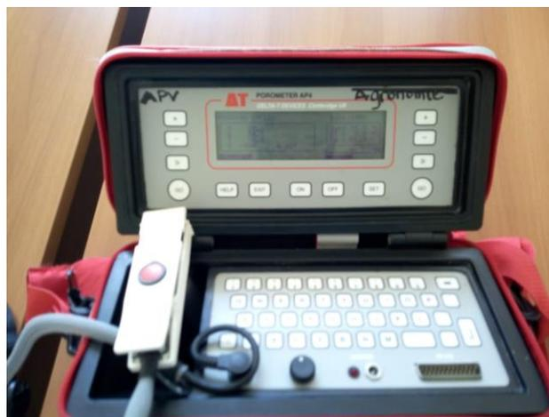
**Figure 3** : Poromètre utilisé
