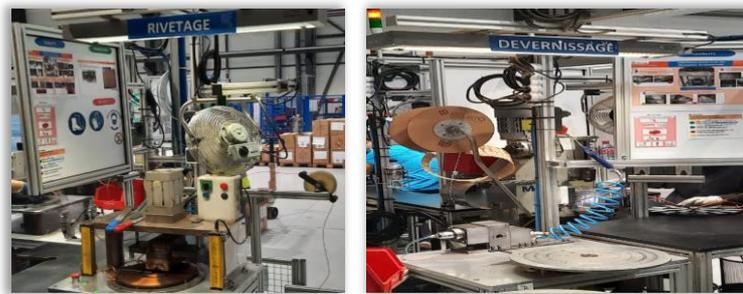
Figure 14 : Stations Rivetage & Dévernissage ligne Inducteur 320
