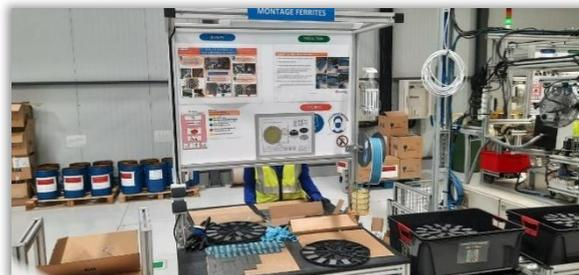
Figure 12 : Station Montage des Ferrites ligne Inducteur 320
