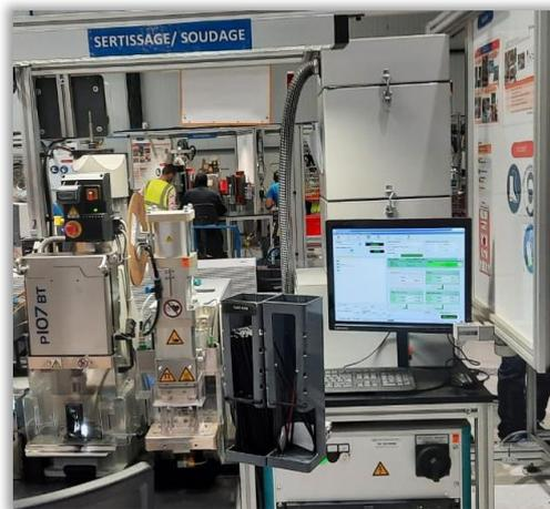
Figure 10 : Machines de Sertissage et Soudage de la ligne MPX 150
