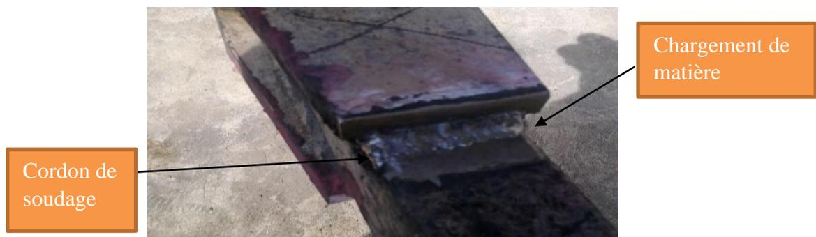
FIGURE 20:SOUDURE CHAPE DOUBLE
