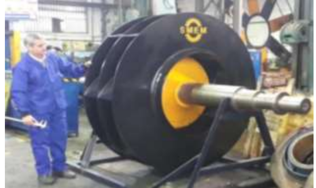
Fabrication de ventilateur double étage en mécanosoudure avec arbre de transmission Client : ONE
