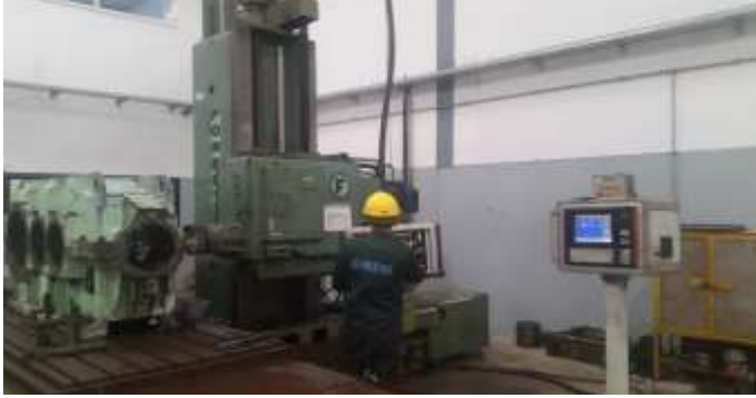
Centre d'usinage CNC Forest de 5x2,5x2m
