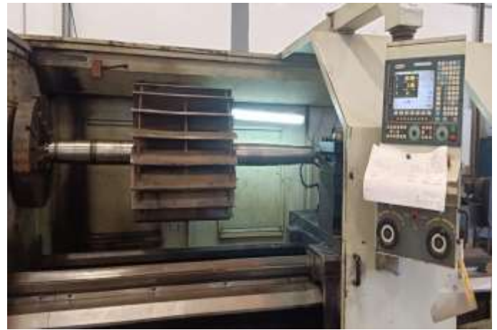
TOUR CNC FAGOR Capacité Ø 1300 X 3000
