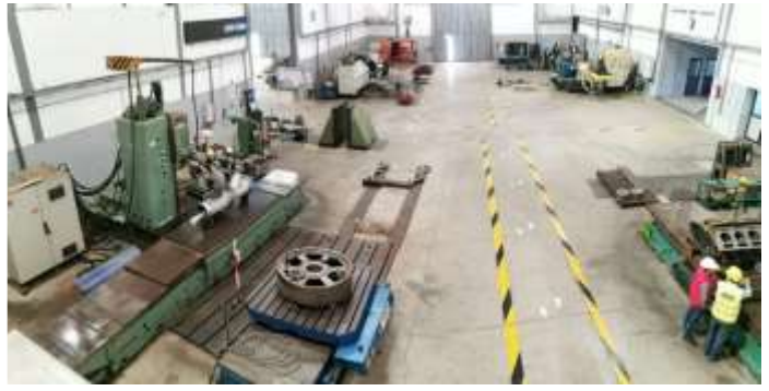
Atelier Commande numérique doté d'un pont roulant de 25 T avec une structure permettant le levage de 35t en cas de besoin
