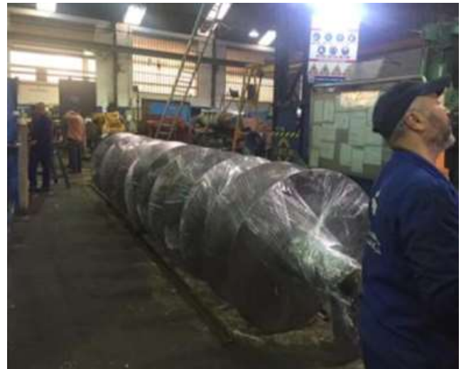
Confection et équilibrage de vis à pulpe Diamètre : 1250 mm - Longueur : 11000 mm - En inox 316L Client : COSUMAR
