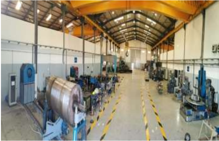
Atelier usinage conventionnel et taillage des roues dentées doté d'un pont roulant de 25T
