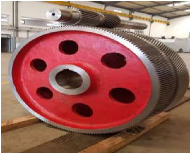
Couple d'engrenage à chevron entraxe 2,1 m
