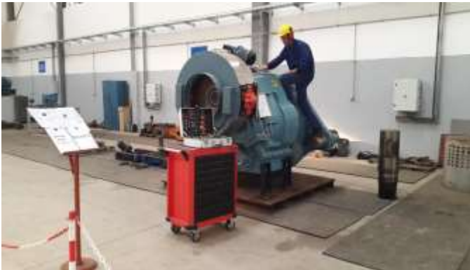
Expertise et remise en état d'un réducteur Siemens pour éolienne
