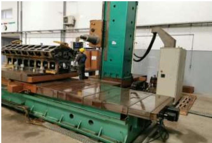
Aléseuse CNC VARANS DORF TOS Capacité 7mx4mx2m
