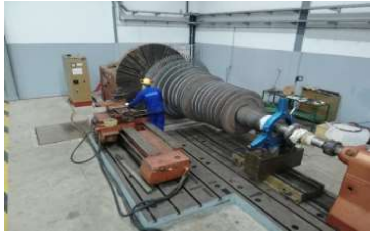
Tour en l'air capacité : Ø 8000 lgr 1200 mm, ou Ø 3200 lgr 8m
