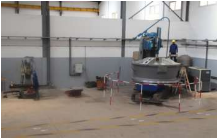
Tour vertical capacité : Ø 5500 mm
