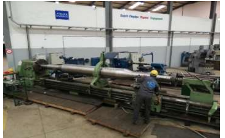
Tour parallèle capacité : Ø 1400 mm longueur 9m
