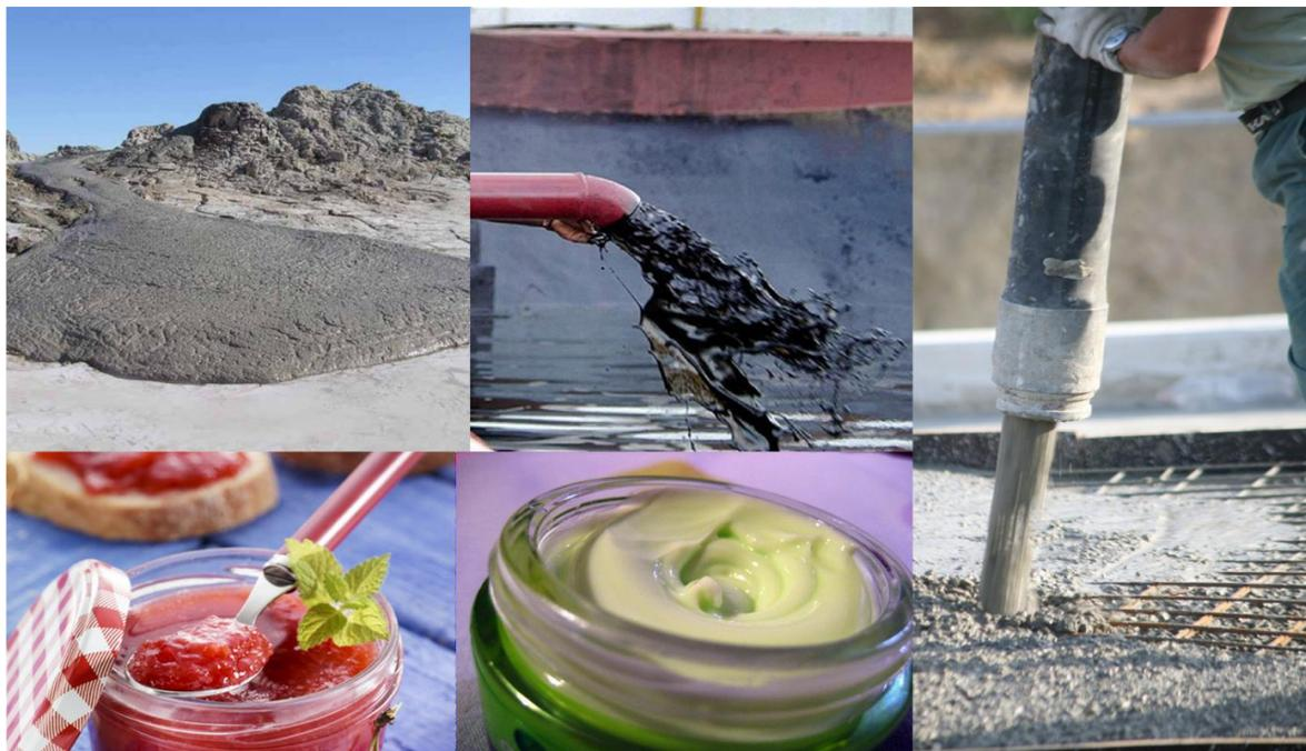
**Figure 1 : Exemples de fluides à seuil ; fluide géophysique, pétrole brut, ciment frais, confiture, crème cosmétique.**
