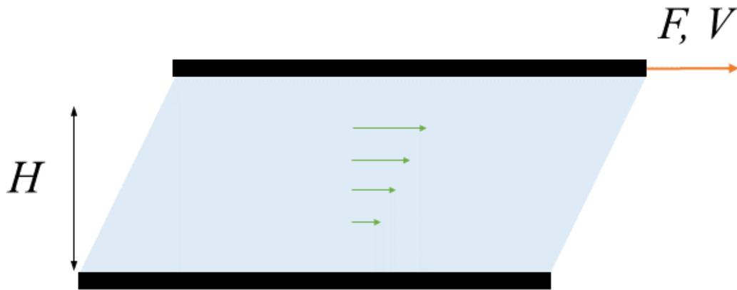
**Figure 2 : Cisaillement simple entre deux plans parallèles.**
