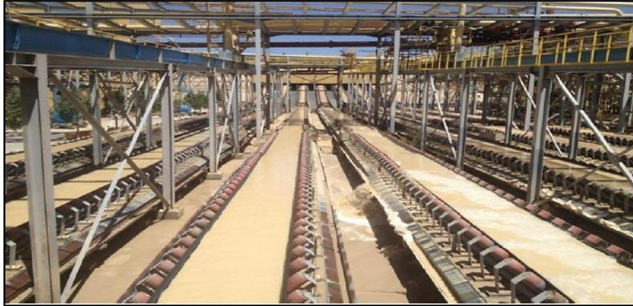
Figure 11:convoyeur séparateur solide-liquide
