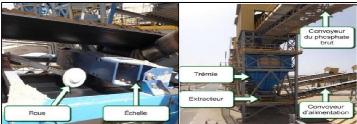
Figure5: Système d'alimentation de chaque chaîne de lavage
