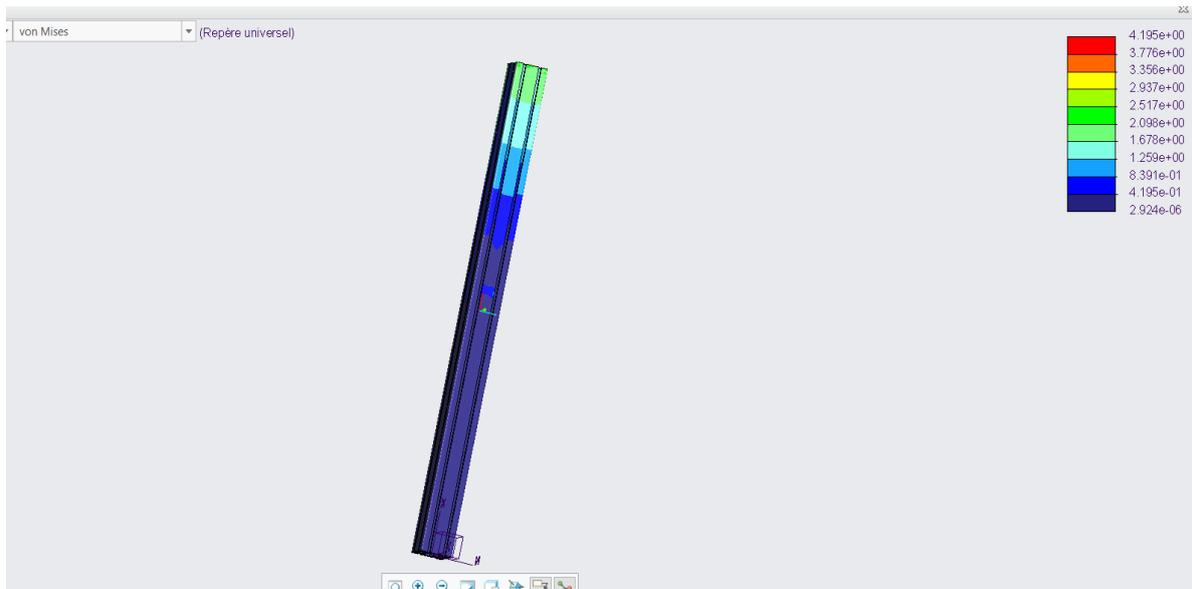
Figure 58: Contrainte de Von Mises de la barre
