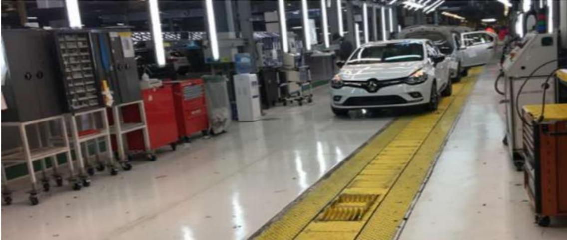
**Figure 8: Ligne SE6-SE8 actuelle (Le convoyeur monotrace sera remplacé par un bitrace)**
