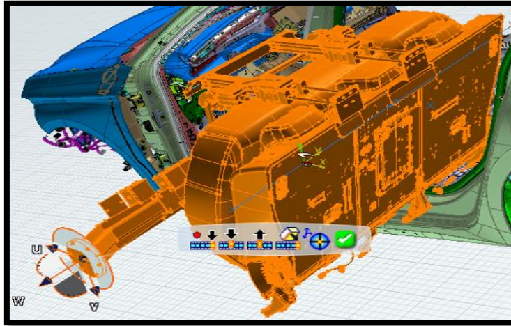
Figure 90: Simulation des trajectoires des sièges AR dans la phase de l'intro
