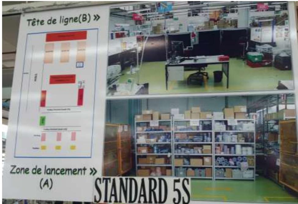
**Figure 19 : Exemple d'application des 5S**
