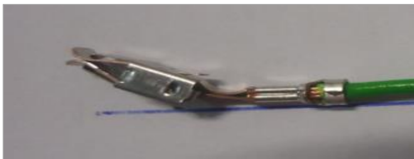
FIGURE 43: PROBLEME D'INCLINAISON (HORIZONTAL) DU TERMINAL.
