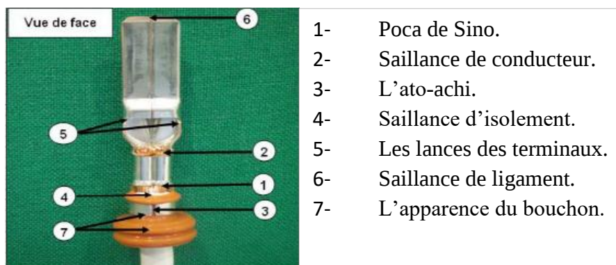
FIGURE 7: LES COMPOSANTES DU TERMINAL.
