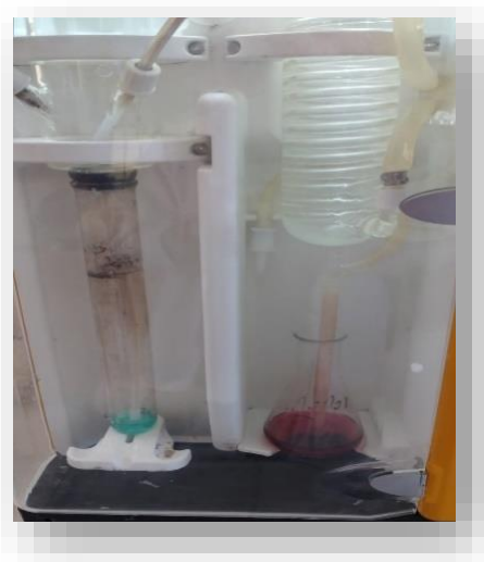
Figure 14 : Appareil de Le distillation
