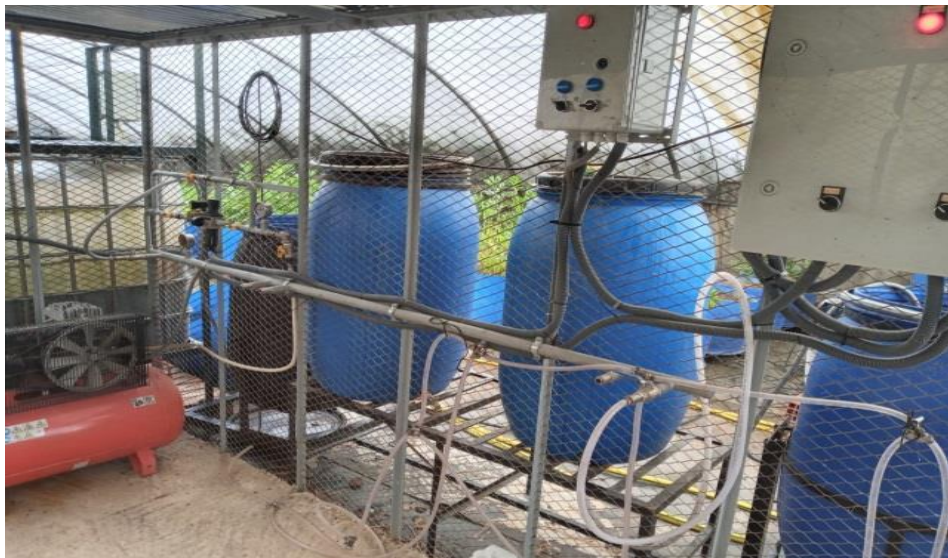
Figure 8: Système d'aération automatique connecté avec le bioréacteur
