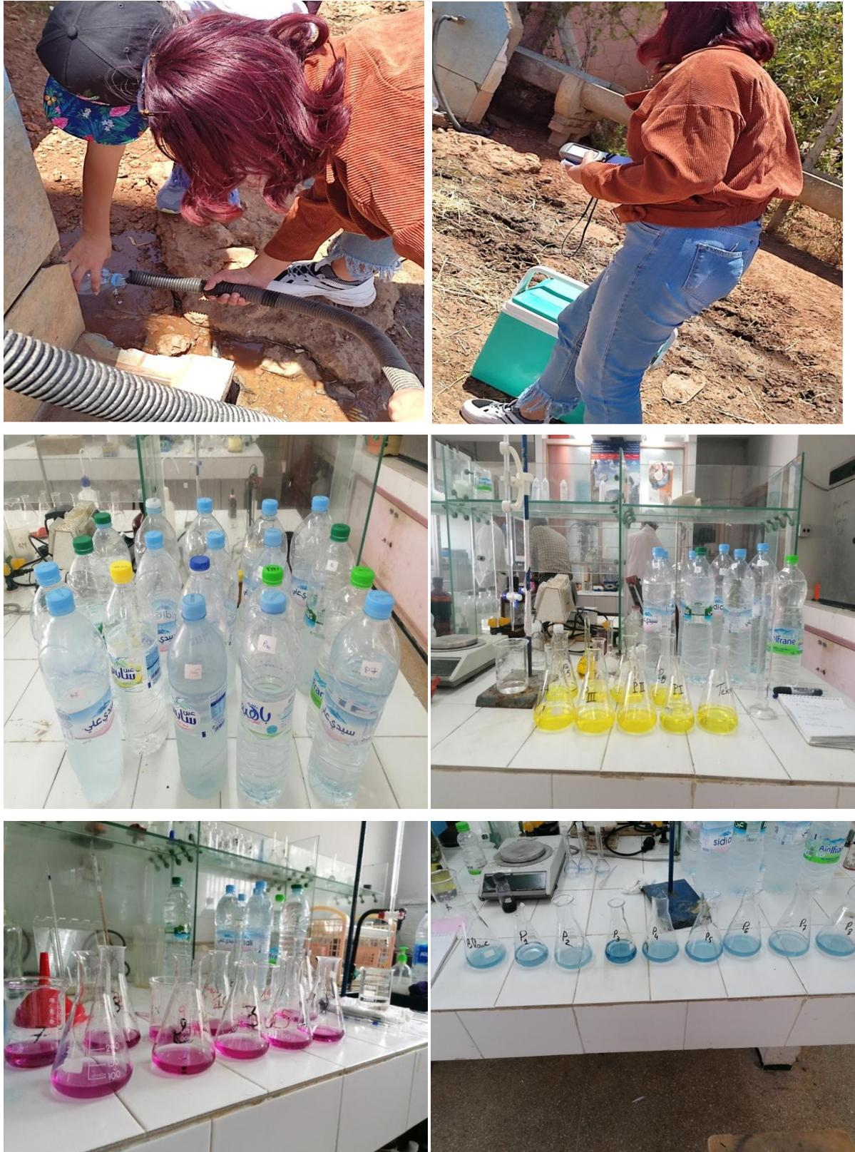
Figure 8 : Photos montrant l'échantillonnage d'eau souterraine et les analyses réalisées
