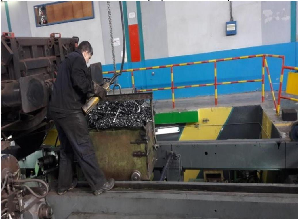
Figure 16:Levage du bac en utilisant le treuil
