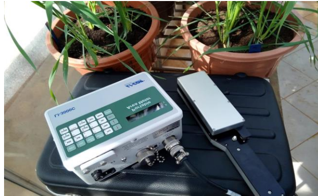
Figure 5: Planimètre (LI-3000C) pour mesurer la surface foliaire.
