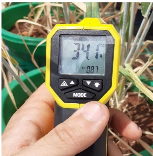
Figure 8:Appareil de mesure de la température foliaire : Thermomètre (CRRRA-Meknès 2021)
