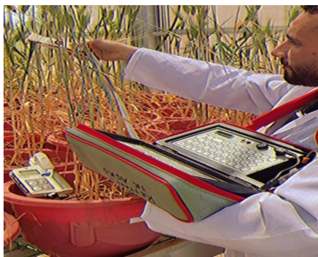
Figure 7: Appareil de mesure de la conductance stomatique : Poromètre AP4 (CRRRA-Meknès 2021)
