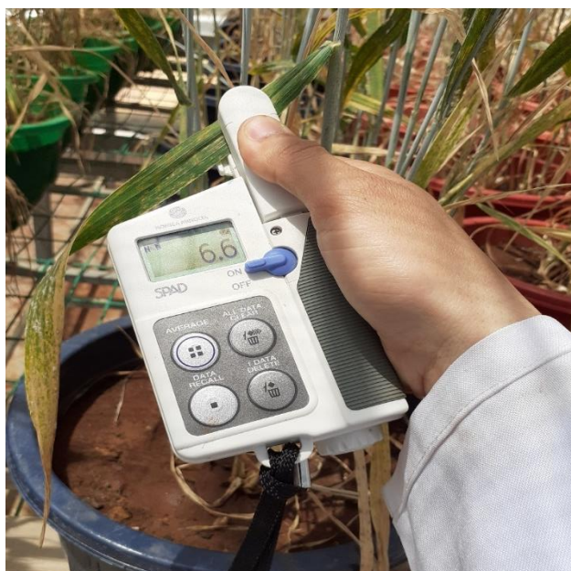
Figure 6: chlorophylle mètre (SPAD) pour mesurer la teneur en chlorophylle (CRRRA-Meknès 2021)
