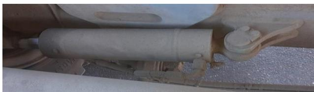
Figure 25 : Vérin hydraulique
