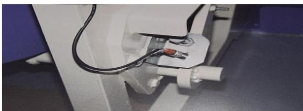
Figure 31 : Interrupteur mou de câble
