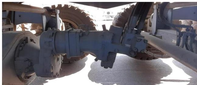
Figure 22 : Accumulateur de pression      Figure 23 : Moteur hydraulique de translation
