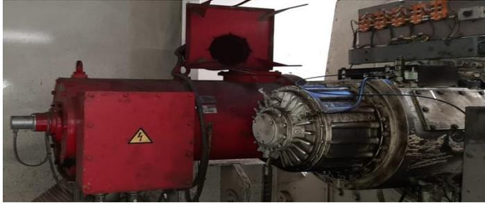
Figure 29 : Moteur (en rouge) et réducteur le levage
