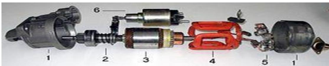
Figure 16 : Vue éclatée d'un démarreur électrique.
