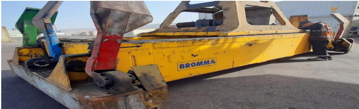
Figure 37 : Spreader de la grue Terex (les flippers sont en rouge/vert et bleu)
