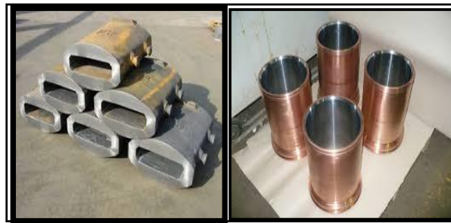
Figure 23: Images sur des lingotières de coulée types "brame et billeterie".
