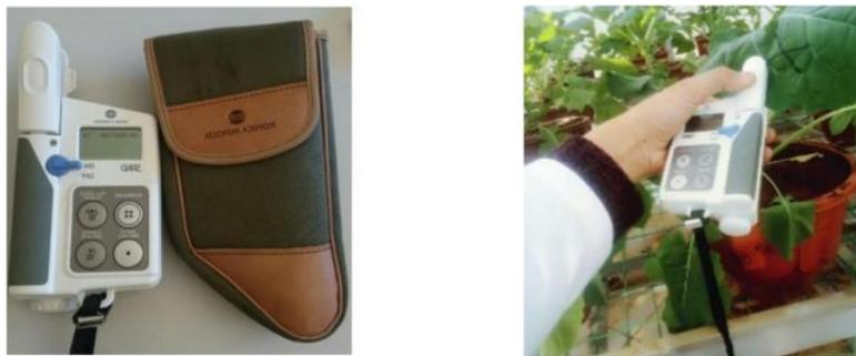
**Figure 5: Chlorophyllomètre de model SPAD-502.**
