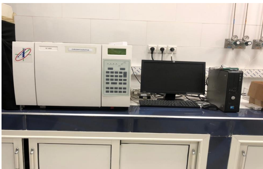
Figure 9: Chromatographe en phase gazeuse du centre de recherche forestière
