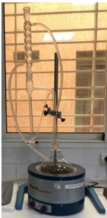
Figure 8: dispositif d'extraction d'huile essentielle de type clevenger du centre de recherche forestière
