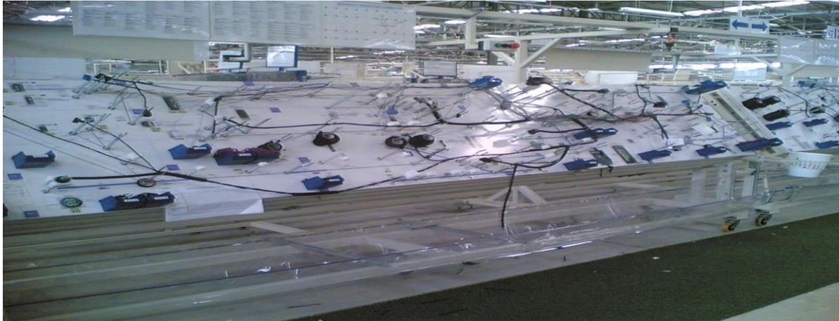
**Figure 12 : Montage sur des Carrousels mobiles**
