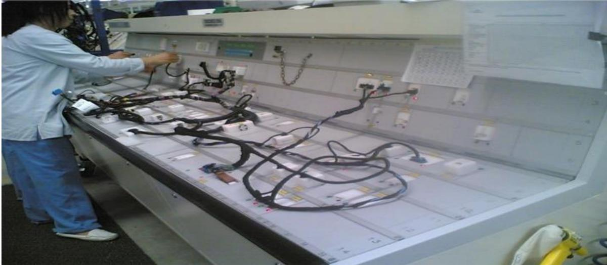
**Figure 13 : Machine du contrôle électrique (SIXTAU)**
