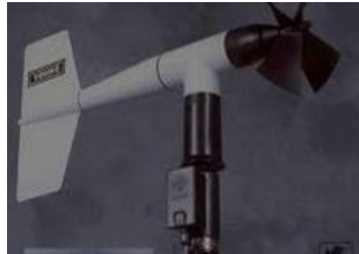
Figure 9 : Anémomètre à hélice
