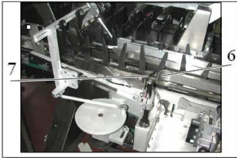
Figure n°25 : Eléments du groupe fermeture des pattes internes de l'étui
