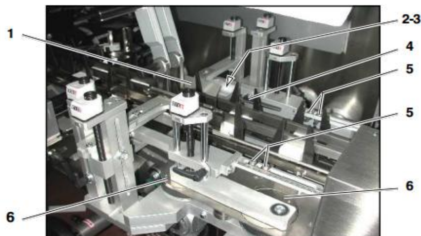
Figures n°23 et 24: Éléments du groupe fermeture des pattes externes de l'étui
