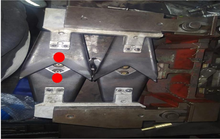
Figure 43 : les lames ciseaux avec les points de contact (en rouge)
