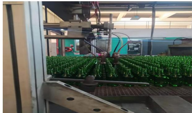
Figure 22 : Sortie de l'arche de recuit
