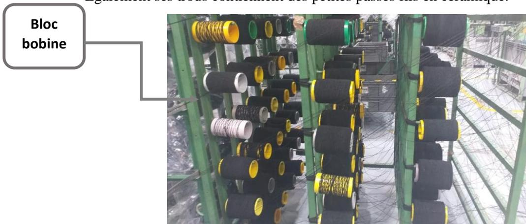
*Figure 18: Représentation des blocs de bobines dans le support initial*
