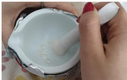
**Figure 19 :** Mouture des graines du blé tendre manuellement à l'aide du mortier.
