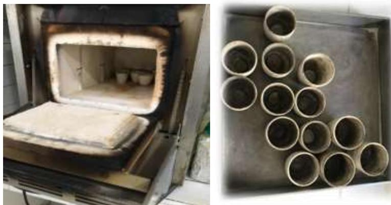
**Figure 19 :** Four industrielle Nobertherm réglé à 550°C
