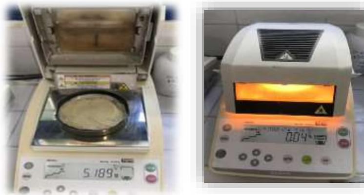
**Figure 18 :** Dessiccateur à résistance chauffante LP16
