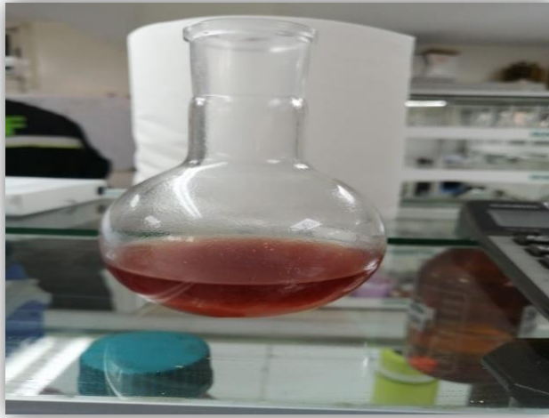
Figure 10 : neutralisation de l'alcool à bruler par KOH (0.1N)
