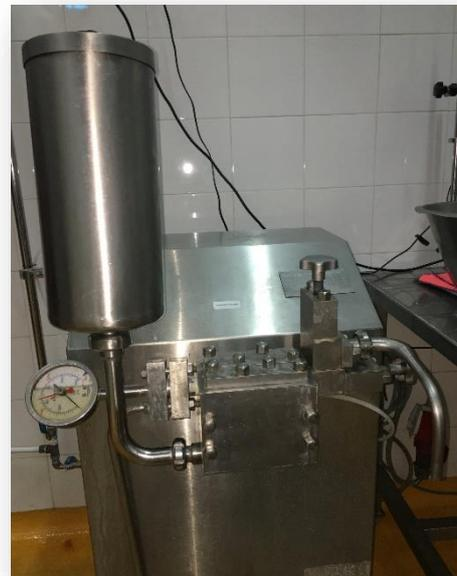
Figure 13 : Homogénéisateur
