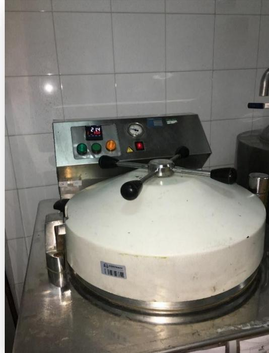
Figure 14 : Autoclave
