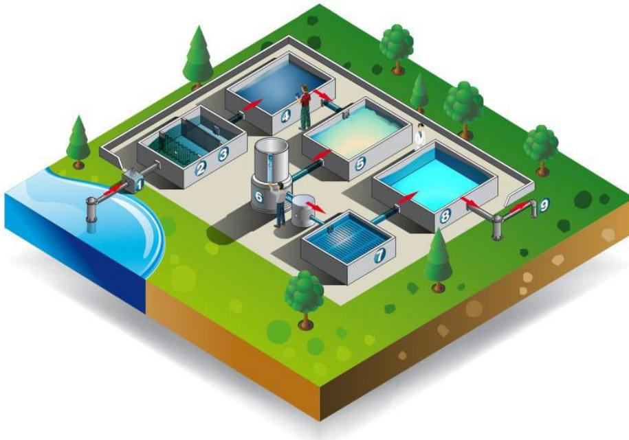
**Figure 4 :** Etapes de production de l'eau potable.
