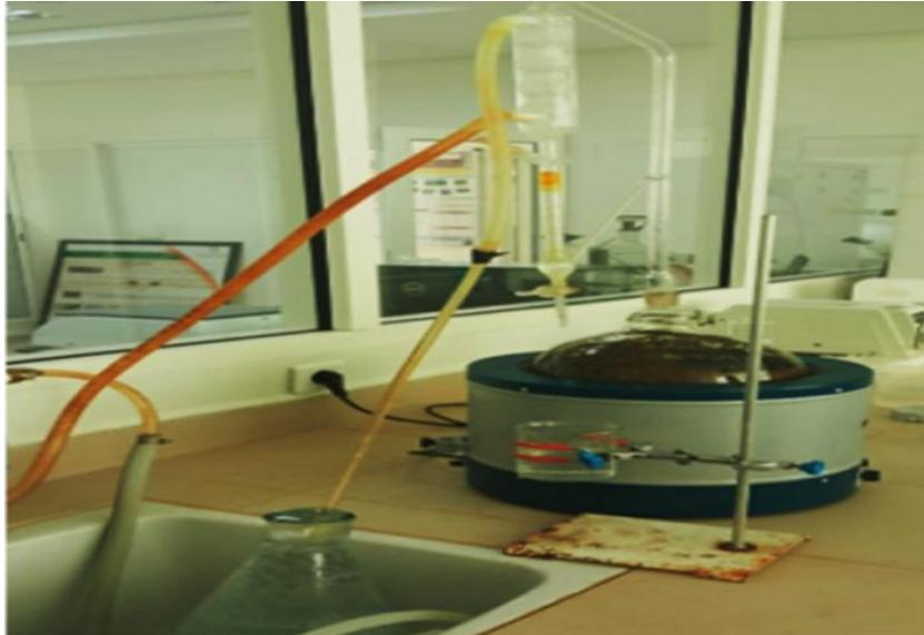
**Figure 4:** Appareil utilisée pour l'extraction des HEs.
