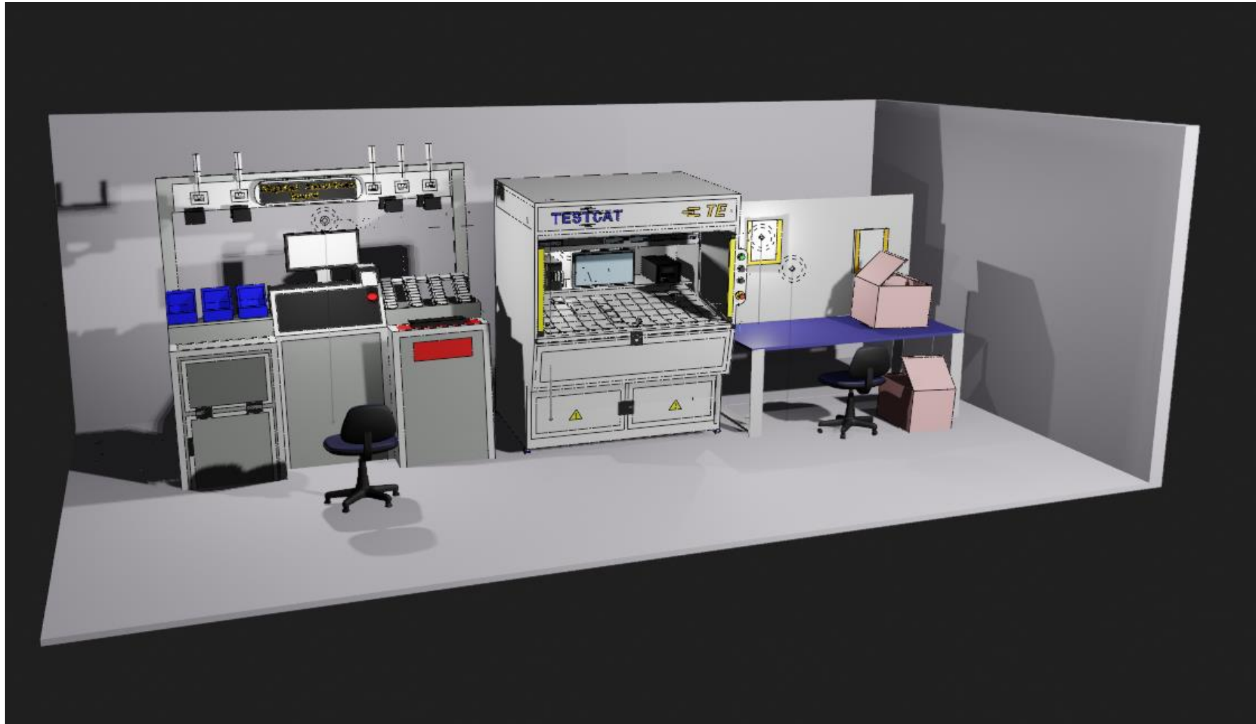
Figure 11: Modélisation de la deuxième partie de la ligne manuelle Mate-ax 90 °
