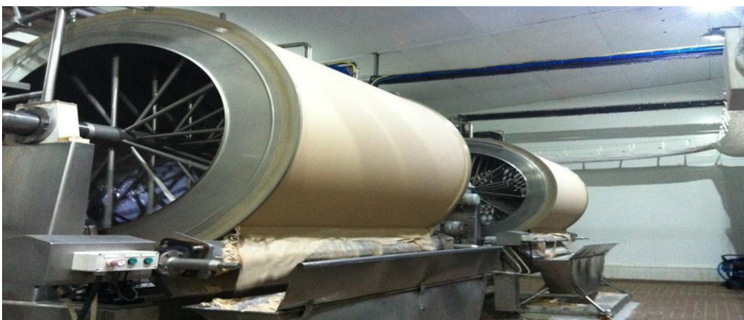
Figure 2.5 : Filtre à tambour rotatif sous vide
