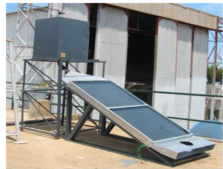
Figure.4: Photographie du séchoir solaire indirect
