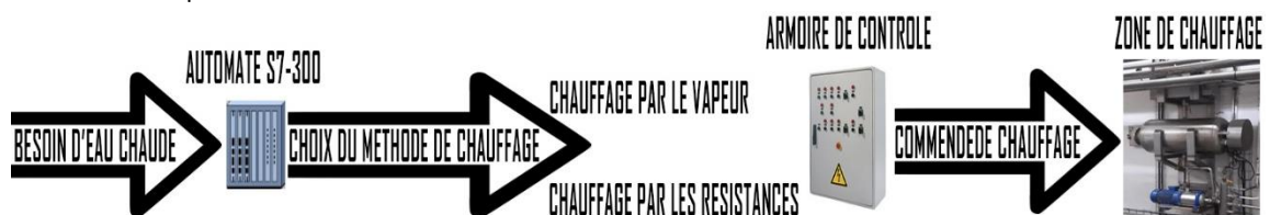
Figure7 : Schéma de la nouvelle procédure du système de chauffage
