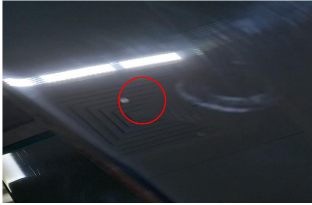
Figure14 : pièce avec le défaut d'un coup
