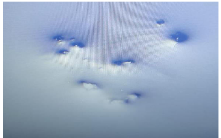
Figure11 : pièce avec le défaut d'un grain
