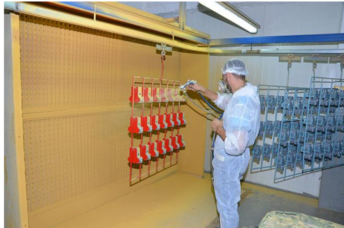
Figure 7 : Peindre les pièces métalliques avec pistolet de pulvérisation.
