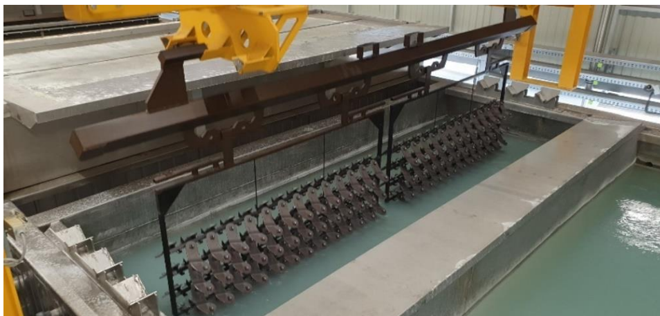
Figure 4 : Traitement de surface des pièces métalliques.
