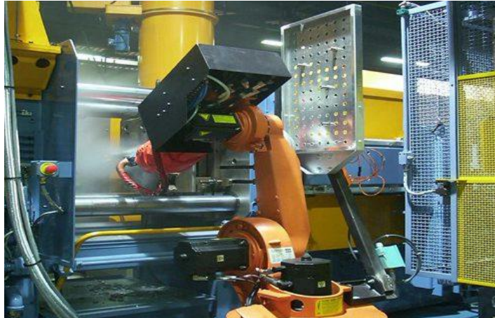
Figure 1: Machine d'injection ZAMAK robotisée.
