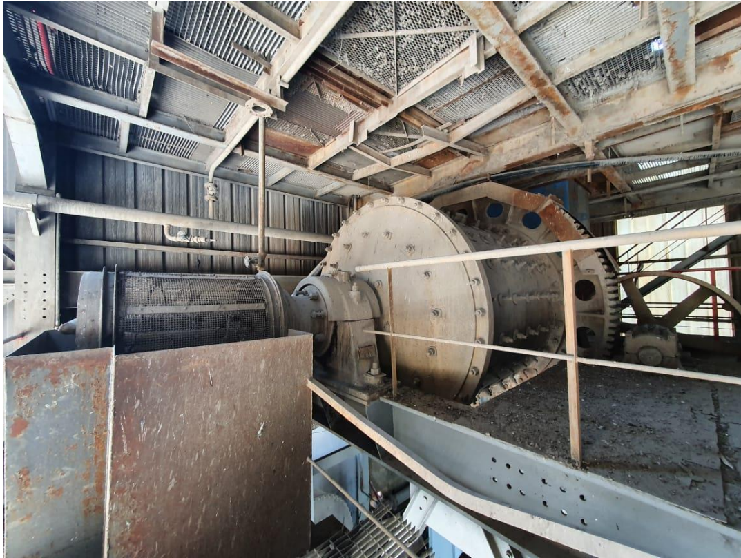
Figure 9 : Broyeur à boulets de capacité 5tonnes/h
