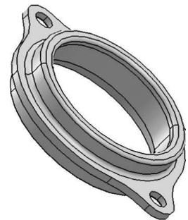
Figure :Bague extérieures de roulement de ligne A7
