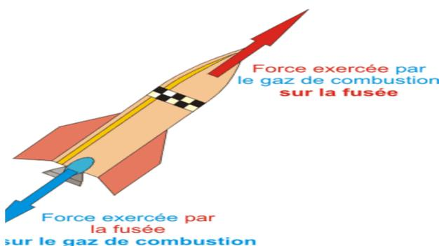
Figure 6 : 3eme Loi de NEWTON propulsion par réaction
