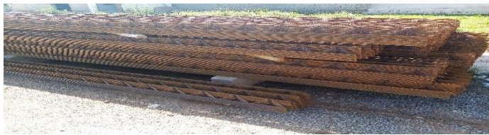
Figure 1.12: les poutrelles nues
