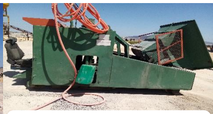
Figure 1.3: La machine électrique de production des briques.
